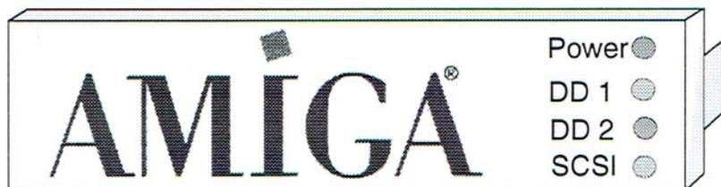
Voici un exemple d'aménagement d'un cache 5 1/4, avec une déco Amiga. Pour parfaire le tout on peut utiliser des LEDs de couleurs différentes et facilement identifier les éléments. Le branchement des LEDs peut se réaliser en soudant les fils ou alors en utilisant des petits fils comportants des fiches dont l'écartement correspond à celui des LED
